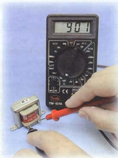
Figura 8.25. Prueba de la continuidad de un transformador con el multímetro
